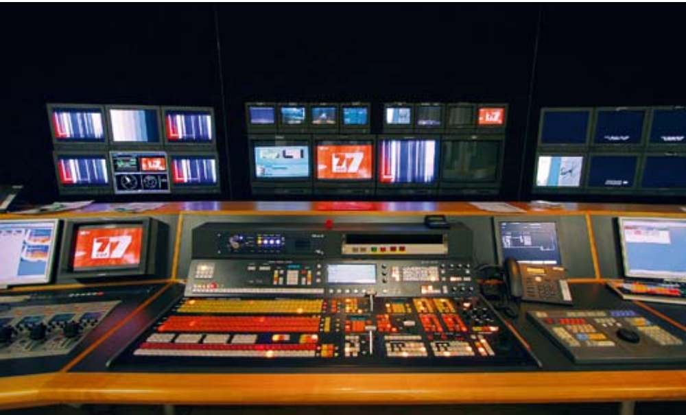
Im Regieraum werden Liveaufnahmen, vorfabrizierte Beiträge und grafische Einblendungen zusammengemischt.
